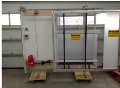
Бокс для привода с выдвижной дверцей на модели штор C3S/325
