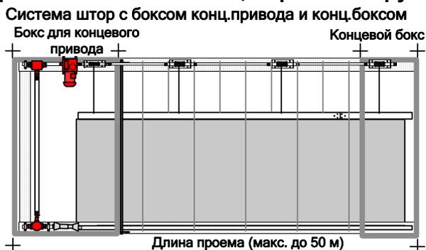
По вышеуказанной таблице Вы можете рассчитать высоту проема здания, высоту тента и систему штор. При ответе на 4 вопроса Вы даете нам базу для расчета Вашей системы штор. При указании длины проема называете, пожалуйста, общую длину, включая концевые боксы. При расчете всех размеров мы исходим из общей длины. От этого зависит также цена.
