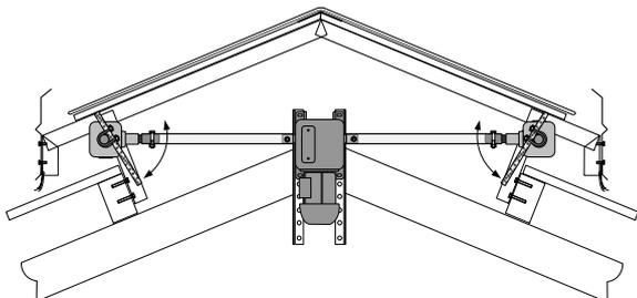
Устройство для откр./закр. с электроприводом
